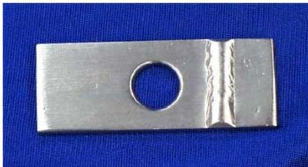
Típicamente, las técnicas de soldadura usadas son las de Shielded Metal Arc (SMAW), Gas Tungsten ARC (GTAW), y Gas Metal ARC (GMAW). Las muestras son preparadas después de la soldadura a menos que se especifique lo contrario, para así suministrar una superficie uniforme para investigación con microscopio.
