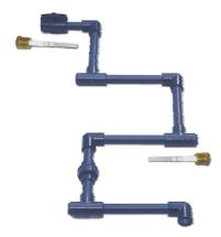
Los sistemas de Derivación son fácilmente instalables en la tubería existente. Normalmente, solo se necesita un Acceso NPT Macho de 1" en el cual el Bypass es adjuntado. Los sistemas de Derivación estándar vienen equipados con 4 ensambles de tapón de tubería, 4 cupones pre-pesados y una válvula de control de flujo de 5 gpm.
