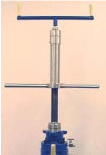
La herramienta de **HOT TAP** de los sistemas de Monitoreo de Corrosión de Metal Samples provee un método seguro y confiable para hacer cortes en caliente (sistemas de acceso de altas presiones en tuberías o contenedores presurizadas).
