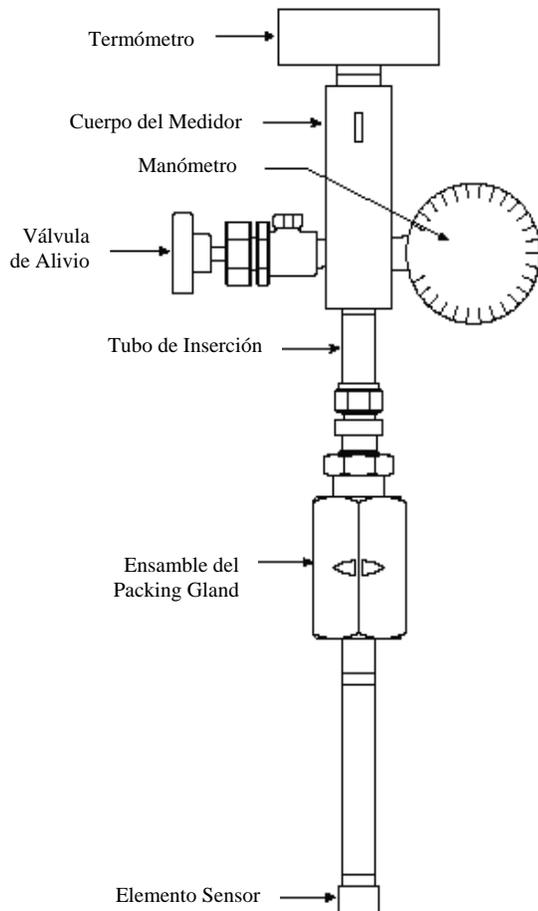
**MODELO HY4000.** Esta, es una Probeta para el monitoreo de hidrógeno que puede ser usada para presiones hasta 1500 psi. Estas son usadas comúnmente para el monitoreo de la penetración del hidrógeno en los aceros, lo cual podría conllevar a quebraduras, formación de burbujas superficiales y decarburización, que pueden resultar en la falla del material.
