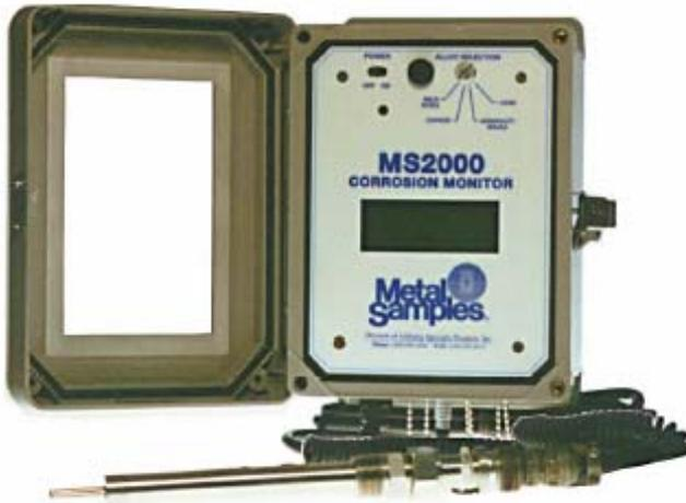
Este Corrosómetro es un transmisor ubicable en el campo, que funciona como microprocesador base. Usando la técnica de resistencia de polarización lineal, el MS2000 permite la determinación rápida de las tasas de corrosión en tiempo real. Un amperímetro cero resistencia de alta precisión es usado para monitorear la corriente electroquímica entre electrodos. La tasa de corrosión y el ZRA son transmitidos en un rango de 4 – 20 mA a través de un puerto serial RS-232.
