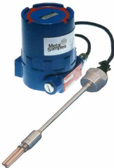
Metal Samples ofrece transmisores instalables permanentemente en el campo para recolección rápida de datos. El MS2500L es un transmisor controlado por micro-procesador que realiza la transmisión a través de dos cables con una corriente de 4 – 20 mA y puede ser localizado hasta 10 millas del receptor. La unidad está diseñada para proveer la tasa de corrosión continua en línea usando la técnica de resistencia de polarización lineal de 3 electrodos.
